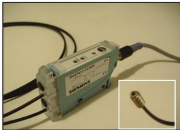
Fig. 2.18. Sensor por reflexión con fibra óptica marca Siemens.
