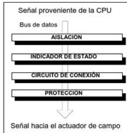
Fig. 3.6. Etapas que conforman una interfaz de salida digital.
