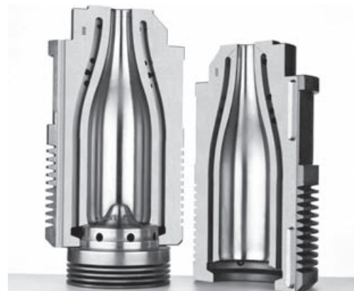
FIGURA 5.8 Moldes para envases de cristal.
